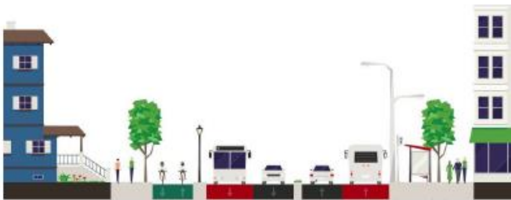
Figura 43 – Seção típica proposta para vias arteriais e arteriais interbairro com implantação de ciclovias
